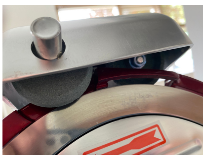
2. Positionnez le module d'aiguisage de sorte que la lame ne soit pas placée entre les petites meules
